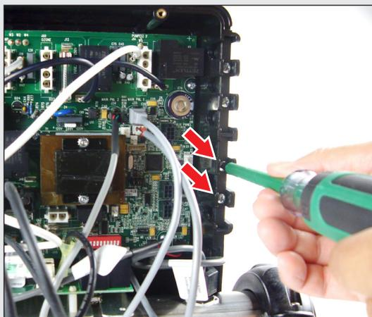
– Remueva 1 tornillo para abrir el sujetador del alambre/cable.
