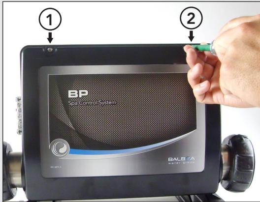
– Utilice un desarmador phillips para remover los 2 tornillos superiores que sujetan la cubierta del sistema en su lugar.
