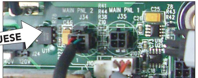
– Introduzca el cable de Wi-Fi Cable en el conector del panel J34 or J35.
