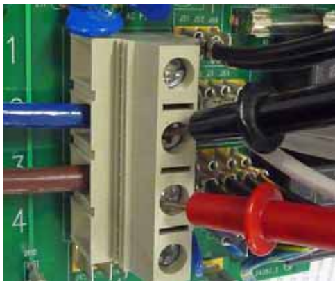
Verifica della Tensione tra il filo blu e il marrone su un Sistema BP2100 230V
