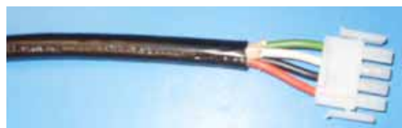
CONNETTORE AMP DELLA POMPA 1
