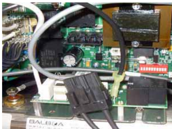
Visione Laterale: Premere la Linguetta di Sgancio per Sbloccare il Connettore
