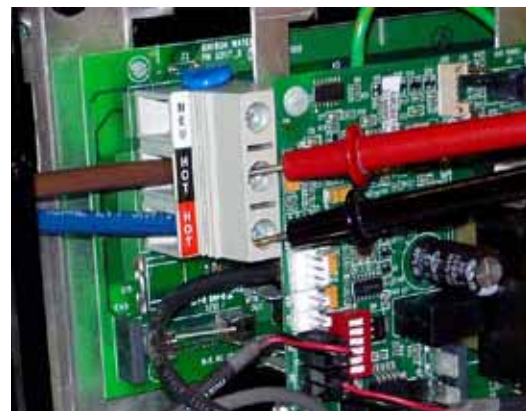
Verifica della Tensione tra il filo blu e il marrone su un Sistema BP600 230V
