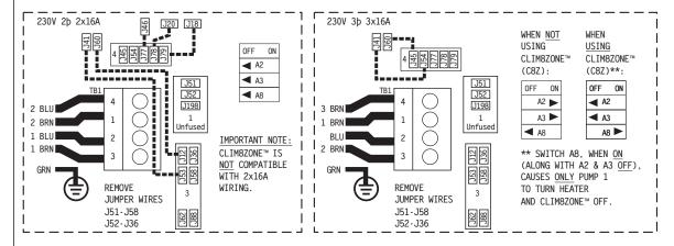
SWITCHBANK S1 OFF SWITCHBANK S1 ON 230V 1þ TEST MODE OFF **◀** A1 TEST MODE ON 1x32A DON'T ADD 1 HS PUMP W/HTR ◀ A2 ADD 1 HS PUMP WITH HEAT DON'T ADD 2 HS PUMPS W/HTR ADD 2 HS PUMPS WITH HEAT DON'T ADD 4 HS PUMPS W/HTR ◀ A4 ADD 4 HS PUMPS WITH HEAT SPECIAL AMPERAGE RULE A ■ A5 SPECIAL AMPERAGE RULE B STORE SETTINGS\* ◀ A6 MEMORY RESET\* 1 MIN HTR COOLDOWN (ELEC) 5 MIN HTR COOLDOWN (GAS) ■ A7 3-PHASE SPCL AMP RULE OFF ◀ A8 3-PHASE SPCL AMP RULE ON NOT ASSIGNED **■** A9 NOT ASSIGNED
